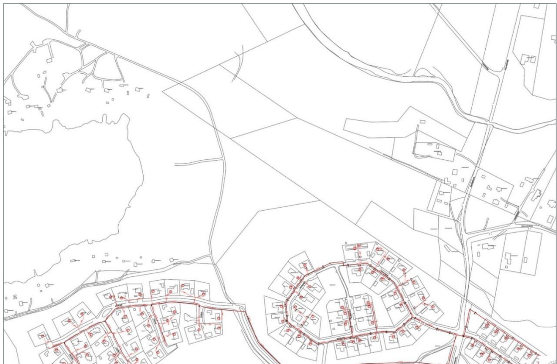
Kuva 11 Ruottalonlahden suunnittelualueen läheisyydessä olevat kaukolämpöjohdot. (Kuva: Raahen Vesi 2018.)
