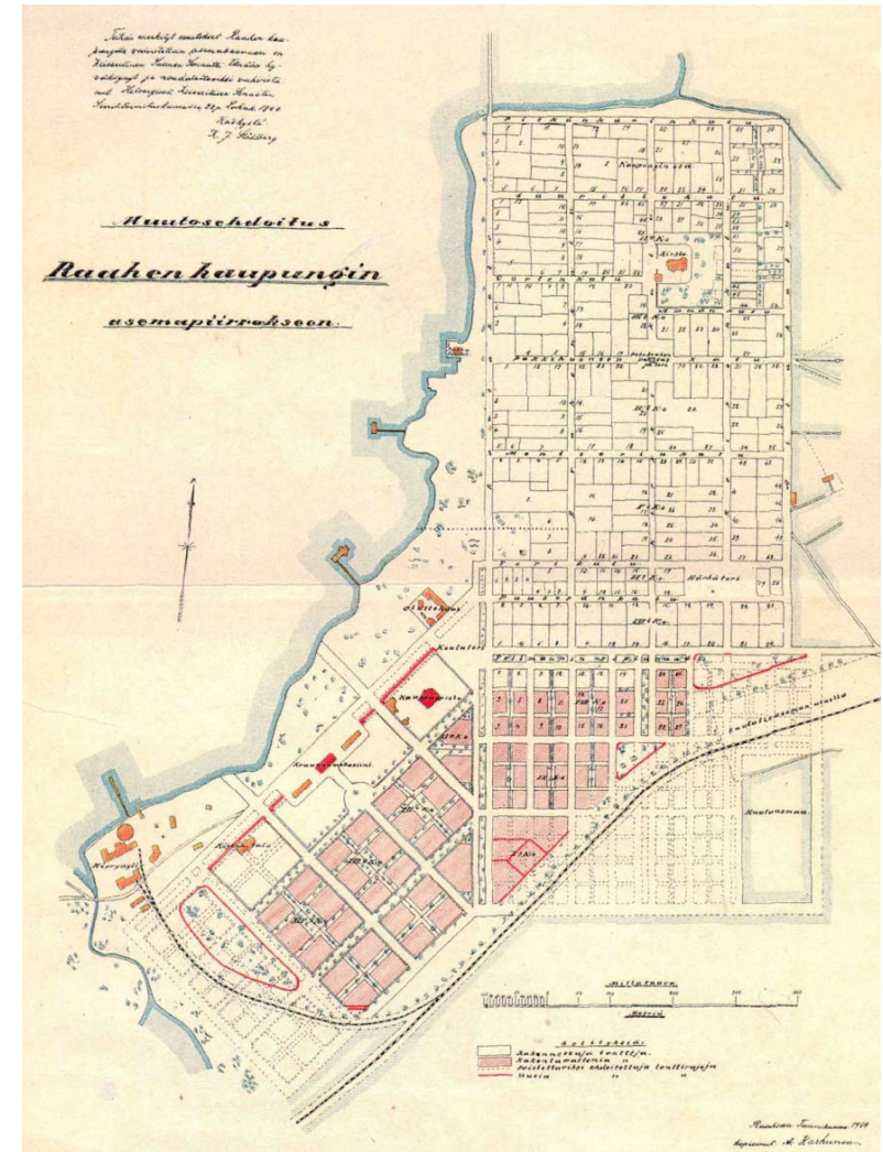
Arthur Engvallin laatima ja Keisarillisen Suomen Senaatin vuonna 1900 hyväksymä ja vahvistama asemakaavan laajennus. Allekirjoitus K. J. Stålbergin. Uutta oli Fellmanin esplanaadin eteläpuolelle laaditut korttelit, joiden suunnittelussa oli huomioitu uudet palomääräykset sekä rautatie, joka kulki kaupungin laidassa.
