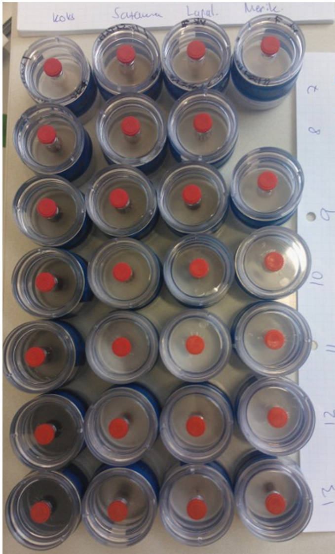
Kuva 9. Suodattimet vasemmalta oikealle: Koksamo, Lapaluodon satama, Lapaluoto, Merikatu; Ylhäältä alas viikot 7-13/2014.
