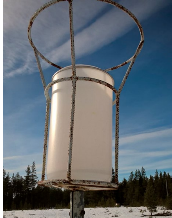
Kuva 44. Laskeumakeräin Lentokentätien mittauspisteellä (kuva Leena Junnila).
